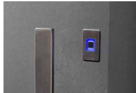
Öffnung über einem im Türblatt eingebauten Fingerleser
